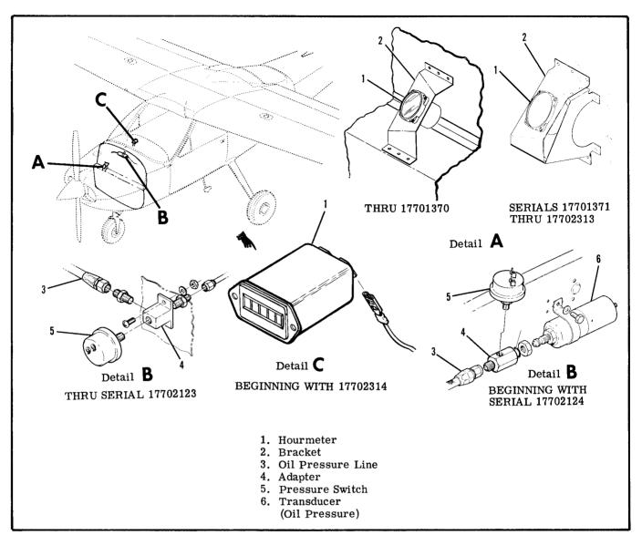
Figure 15-7. Hourmeter Installation
