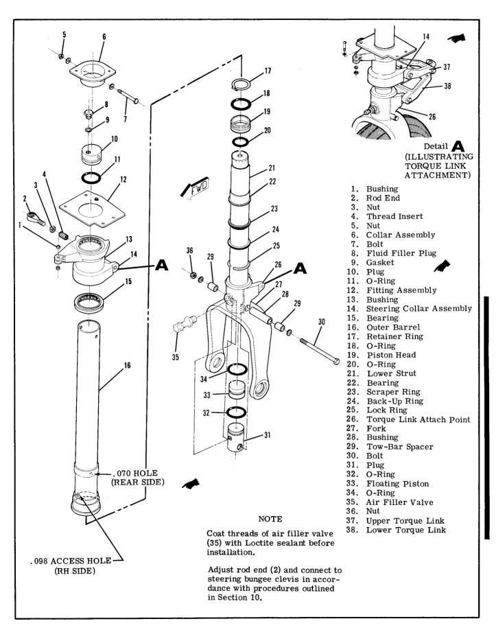
Figure 5-9. Nose Gear Shock Strut
