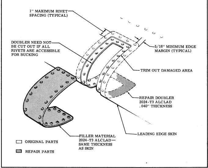
Figure 18-8. Leading Edge Repair
