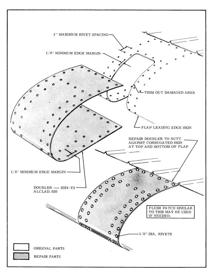
Figure 18-9. Flap Leading Edge Repair
